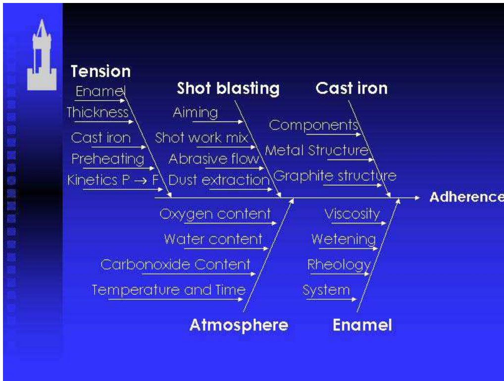
Fig 6. Visión conjunta de las causas que influyen en la adherencia del esmalte vítreo sobre el hierro fundido.
