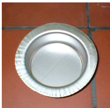
Figura 3.: Vasija de prueba hecho de acero inoxidable ST4301.
