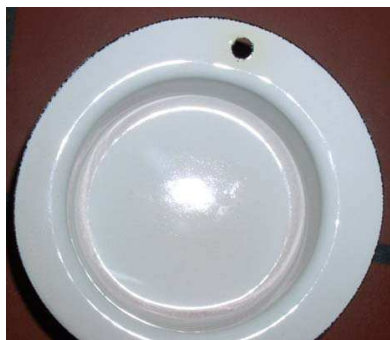
Figura 2.: Vasija de prueba con esmalte blanco con contenido de plata
