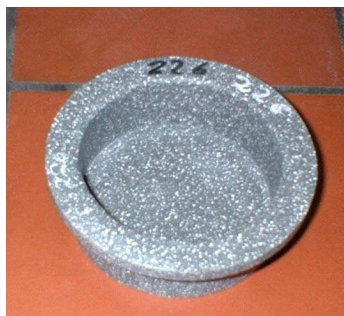
Figura 4.: Vasija de prueba recubierta con materiales plásticos.
