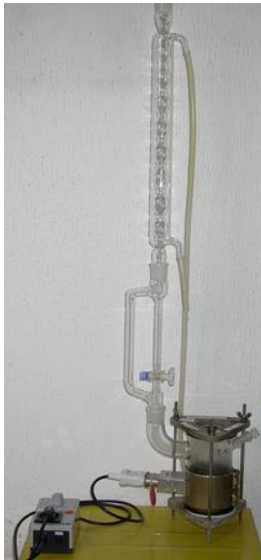
Figura 3: Equipo de ebullición según EN 14483-2
